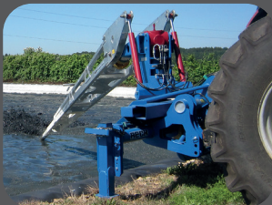
Pied de maintien réglable en hauteur par hydraulique
